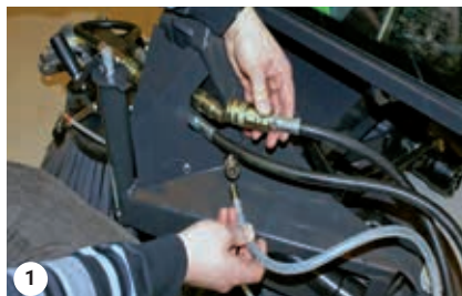
Hydraulikslanger + vandslanger på A-rammen monteres
