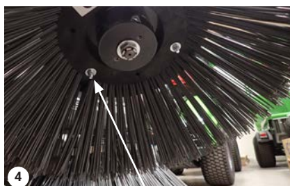
Løsn 3 møtrikker, og udskift børste
