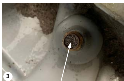
Rengør stålfilteret ved vakuomet
