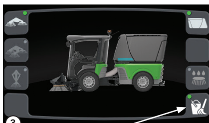
Tryk og hold "bucket" nede i 3 sek., indtil det grønne lys tændes.
