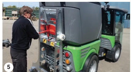
Skub stativet og sørg for, at krogene er på plads i løfteanordningerne.
