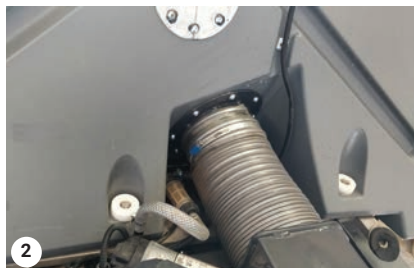
Fjern den eksterne sugeslange ved at løsne slangeklemmen
