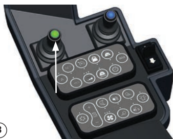
Venstre joystick til venstre børste Højre joystick til højre børste
