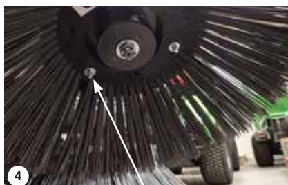
Løsn 3 møtrikker, og udskift børste
