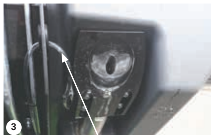
Løsn slangen, dræn overskydende vand
