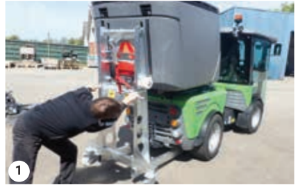
Påmontering af sugetank
