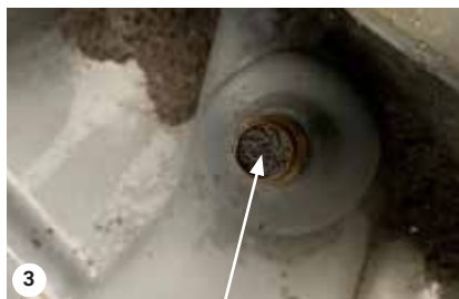
Rengør stålfilteret ved vakuümet
