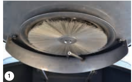
1 Kontrol af det roterende filter og turbinen
