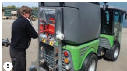
Skub stativet og sørg for, at krogene er på plads i løfteanordningerne.
