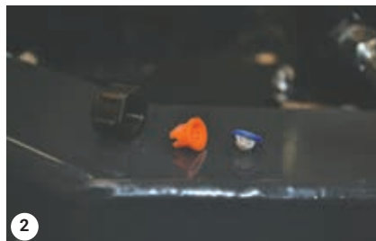
Tag filter og dyse ud og rengør
