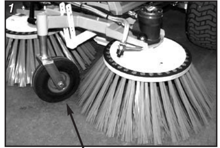
Næsehjul til højdejustering af koste
