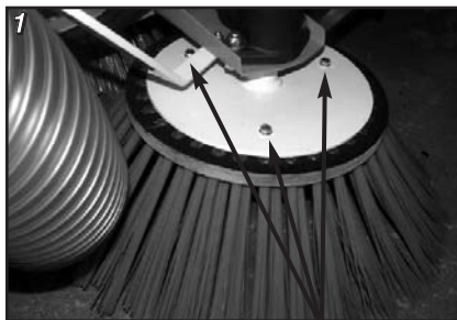
Udskiftning af koste: bolte løsnes
