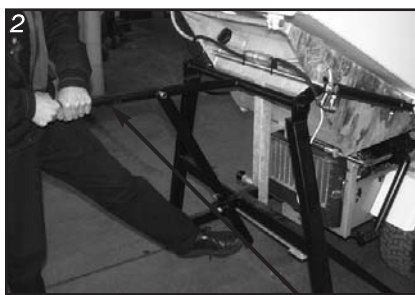
Sænkning af opsamlingstank Løftestang
