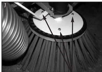
Udskiftning af koste: bolte løsnes
