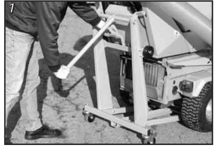
Sænkning af opsamlingstank
