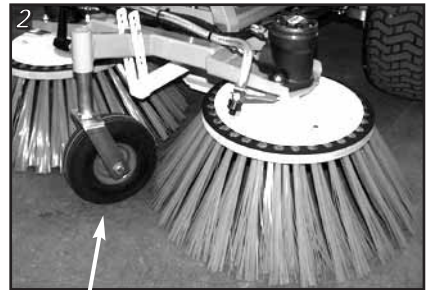
Næsehjul til højdejustering af koste
