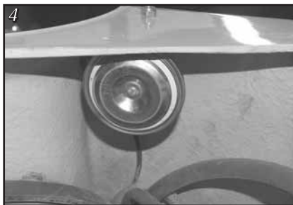
Kontroller at stikkene er sat på lydgifveren
