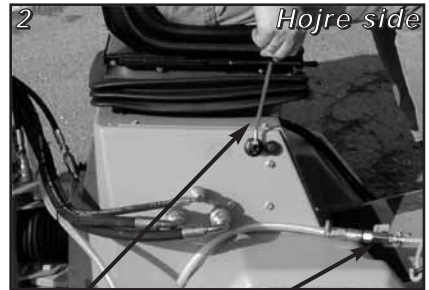
Håndtag D Hane til dyser foran koste
