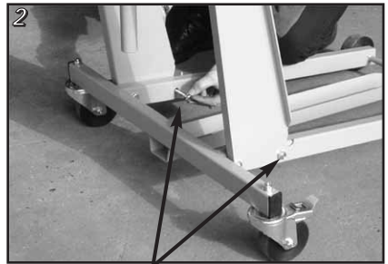
2 bolte på tankstativet
