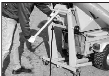
Sænkning af opsamlingsstank
