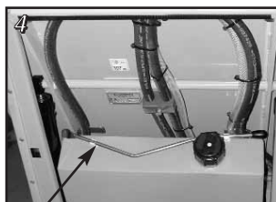
Rengøringsværktøj til turbine
