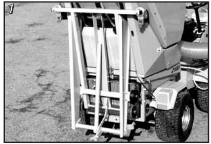
Transport af tankstativ på opsamlingstank
