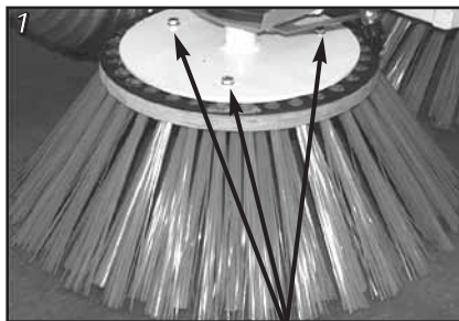
Udskiftning af koste: Bolte løsnes
