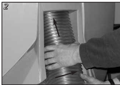
Påmontering af sugeslangen
