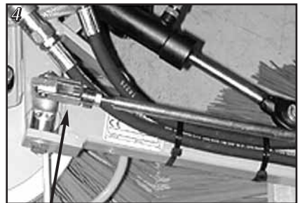
Beslag til justering af vinkel på sidekost
