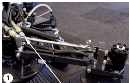
Beslag til justering af vinkel på sidekost
