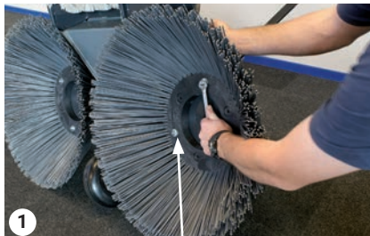
Udskiftning af koste: Bolte løsnes
