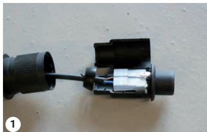
1 Brun ledning til + og blå ledning til -
