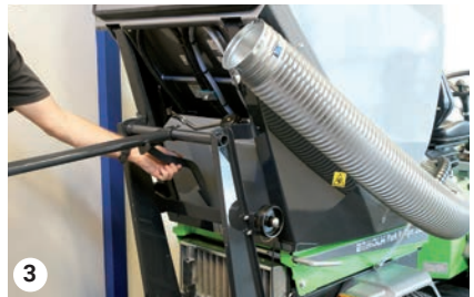
Sænkning af opsamlingstank
