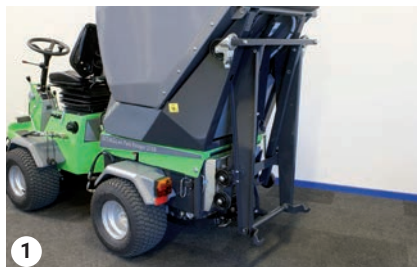
Transport af tankstativ på opsamlingstank
