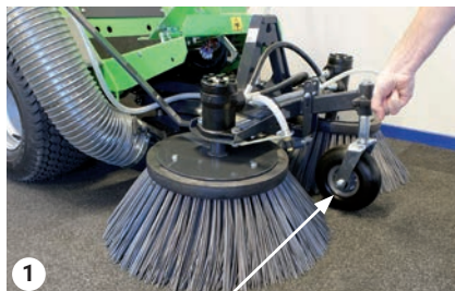
Næsehjul til højdejustering af koste
