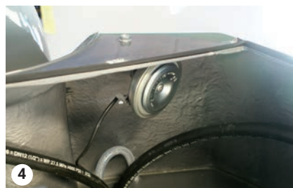
4 Kontroller at stikkene er sat på lyd giveren
