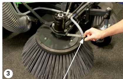
Vanddyser foran de 2 standard koste
