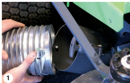
Fastklemt materiale fjernes
