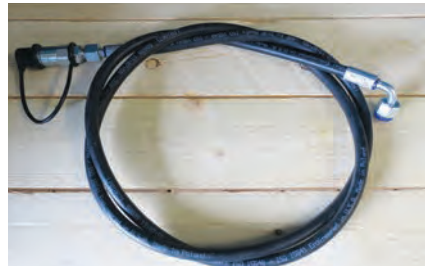
Kobling monteret på den lige ende af den korteste slange.
