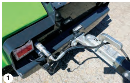
Tilslut trailerkoblingen, hydraulikslangen (og strømstikket, hvis det er tilgængeligt).
