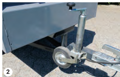
Sørg for at indstille næsehjulet i øverste position.
