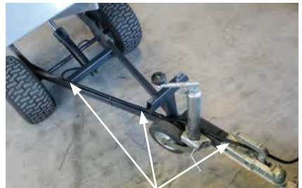
Slange monteret på traileren.
