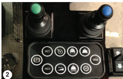
Venstre joystick - venstre vinge Højre joystick - højre vinge
