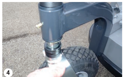
4 Placér afstandsringe mellem hjul og klipperens ophæng.
