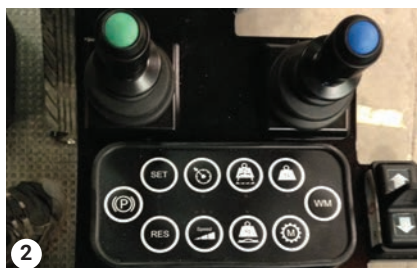
Venstre joystick - Sænk klipperen Højre joystick - Vip klipperen
