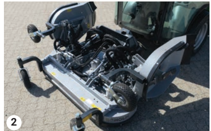
2 Knive i løftede vinger stopper automatisk
