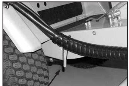
Slinger fastgøres med gummistrop
