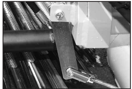
2-3 mm afstand mellem metal og A-ramme
