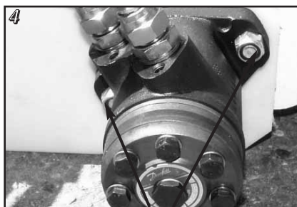
Løsn boltene, der holder oliemotoren
