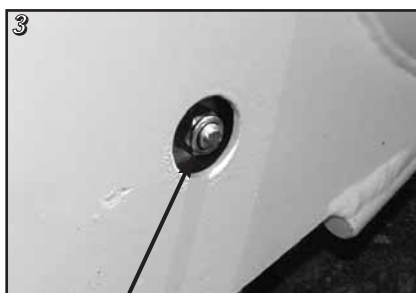
Løsn boltene, der holder børstevalsen
