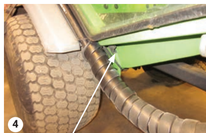
Slangerne er fastgjort med en gummistrop
