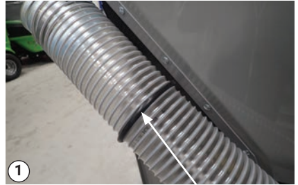
Gummiring monteret på sugeslangen
