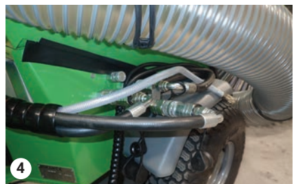
Monter hydraulikslangerne på D-udtagene
