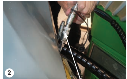
Monter de små slanger fra ukrudtsbørsten på sugetankens udtag
