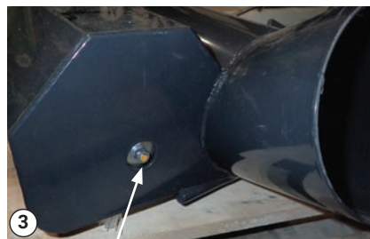
Løsn bolten, der holder børstevalsen
