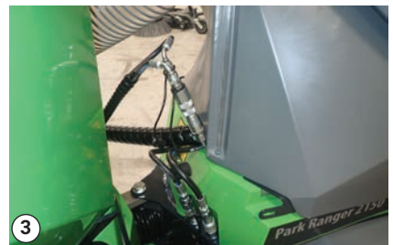
Monter hydraulikslangerne fra sugetanken på C-udtaget
