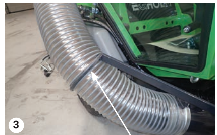
Gummiring monteret på ukrudtsbørstens beslag
