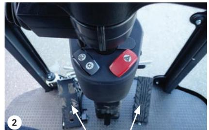
2. Inch/brake pedal 1. Drive pedal
