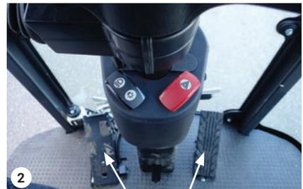
Inch/brake pedal Drive pedal
