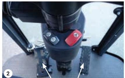
2. Inch/brake pedal 1. Drive pedal
