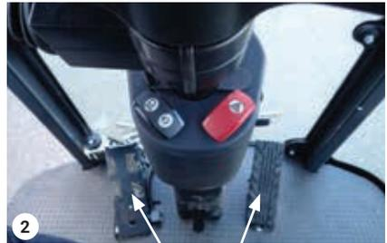
Inch/brake pedal Drive pedal
