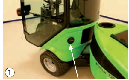
Llenado de combustible
