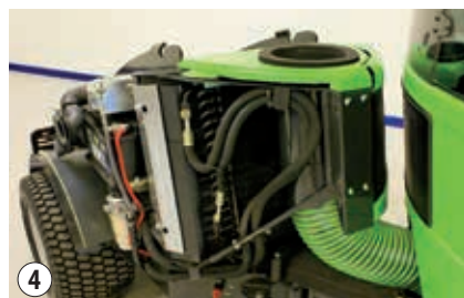
Limpie los radiadores con aire comprimido
