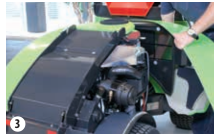
Desinstalación de la cubierta lateral
