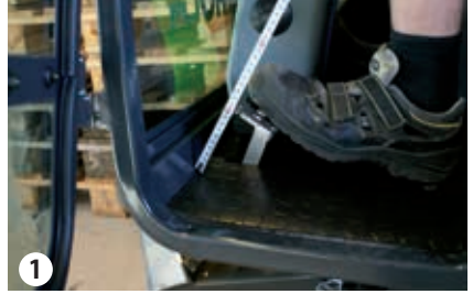
Compruebe la carrera del pedal, 3-5 cm
