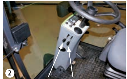
Bloqueo de transporte Bloqueo de estacionamiento
