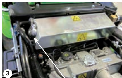
Depósito de expansión - controlar el refrigerante
