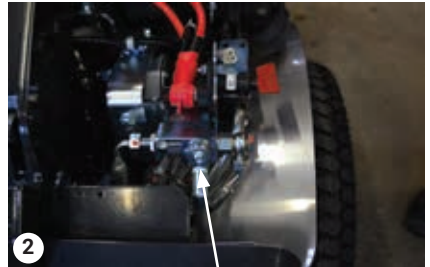
2 Válvula de remolque en posición cerrada
