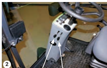
Bloqueo de transporte Bloqueo de estacionamiento
