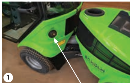
Llenado de combustible
