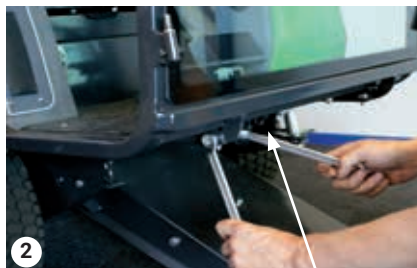
2 Tornillos bajo la placa de base
