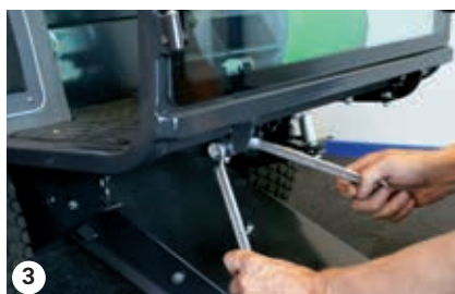
Tornillos bajo la placa de base
