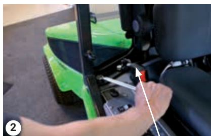
Retire los tornillos, dos de cada lado
