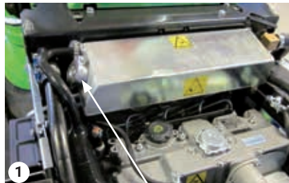
Tapón del líquido de refrigeración en el depósito
