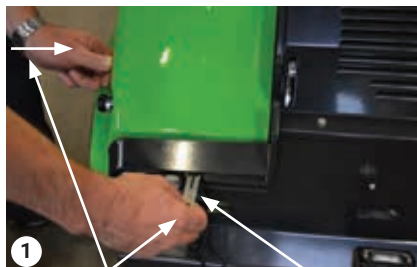
Presión ligera en la llave de desactivación y en la cubierta lateral Llave de desactivación
