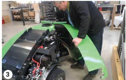
Extracción de las cubiertas laterales
