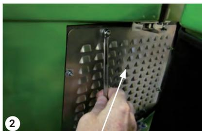
Placa de acero y junta de caucho
