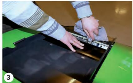
Limpie el conector rápido, bastidor B
