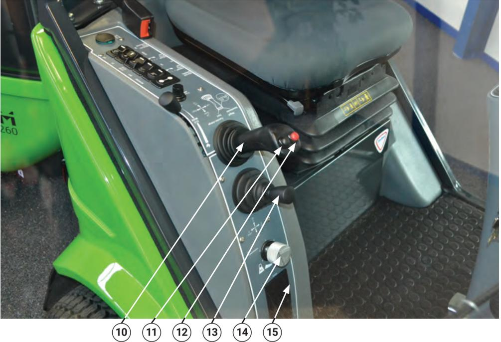
10. Palanca de mando para el bastidor A.
