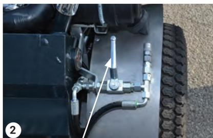
Válvula de remolque en posición cerrada
