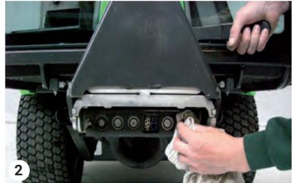
Limpie el conector rápido, bastidor A
