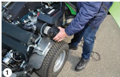
Carcasa del filtro de aire/elemento filtrante
