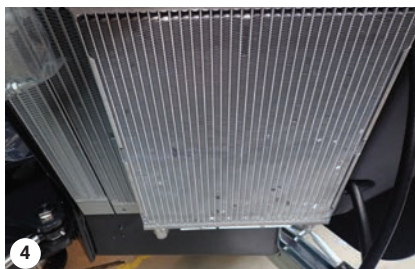
Condensador del aire acondicionado
