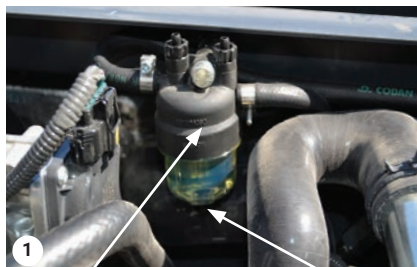
Filtro decantador de combustible Tapón de drenaje
