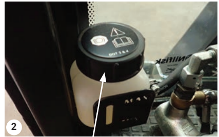
Cubierta del tanque
