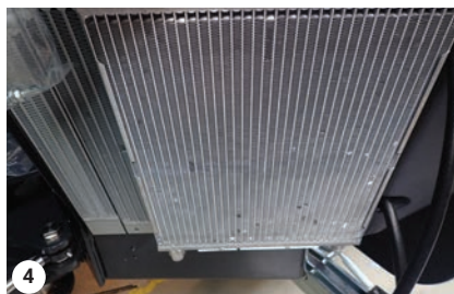
Condensador del aire acondicionado
