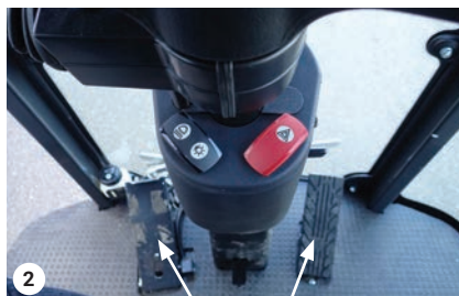
2. Pedal de freno/ avance lento 1. Pedal de marcha
