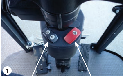
Interruptor de las luces Interruptor de peligro
