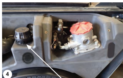
Tapón de llenado hidráulico
