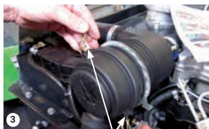
Afloje la carcasa del filtro
