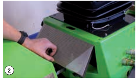
Montaje de la cubierta del enfriador de aceite
