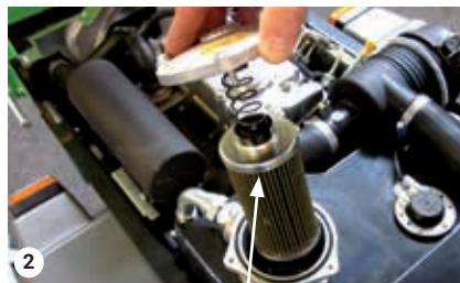
Filtro del depósito
