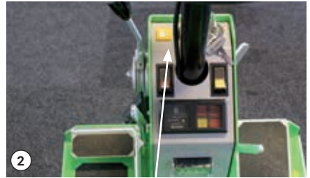
Piloto de control del nivel de gasóleo
