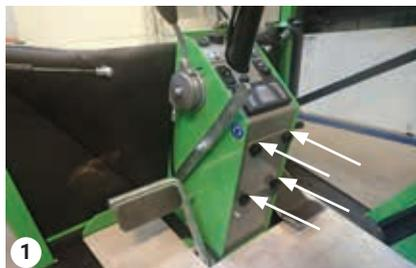
Fusibles del panel del volante
