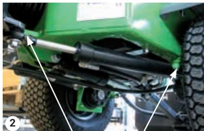
Boquillas de lubricación (cilindros de la dirección)
