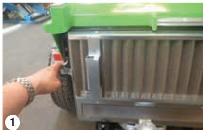
Desmonte la cubierta del radiador
