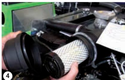
Desmonte el elemento filtrante del filtro de aire
