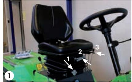
Palancas de ajuste del asiento del conductor
