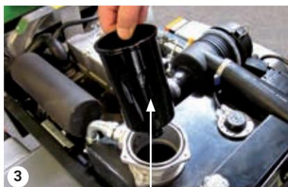
3 Carcasa del filtro del depósito
