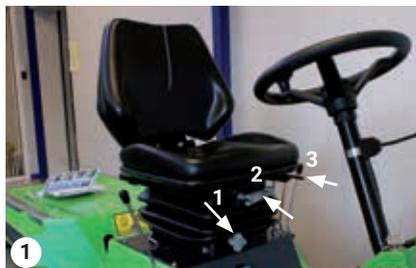
Palancas de ajuste del asiento del conductor
