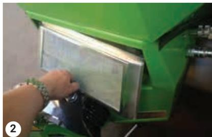
Montaje de la cubierta del enfriador de aceite
