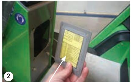
Lista de fusibles (tras la cubierta de los fusibles)
