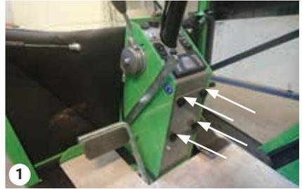
Fusibles del panel del volante
