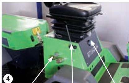
4 Conectores hidráulicos D1, D2 y D3 Palanca D Regulación de velocidad
