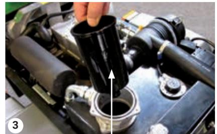
Carcasa del filtro del depósito
