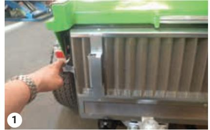
Desmonte la cubierta del radiador
