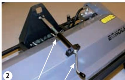
Clavija hendida Palanca de ajuste fino
