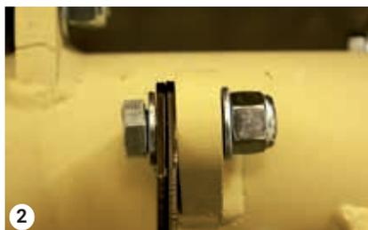
Pernos para la colocación de las cuchillas
