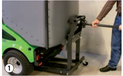
Sujete el colector de hierba a la máquina
