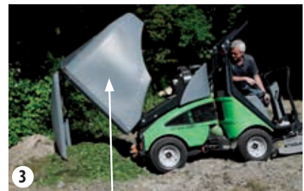
El colector de hierba está basculado completamente hacia atrás
