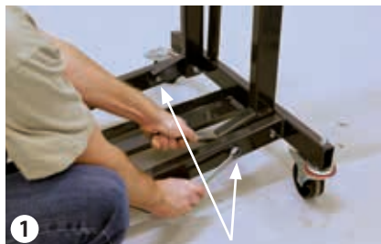
2 tornillos en el soporte del colector
