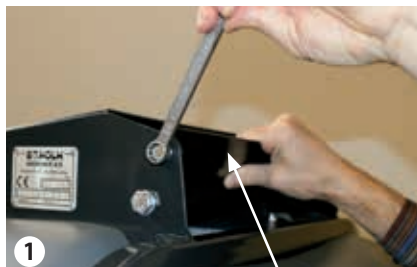
Registro giratorio en la parte superior del colector
