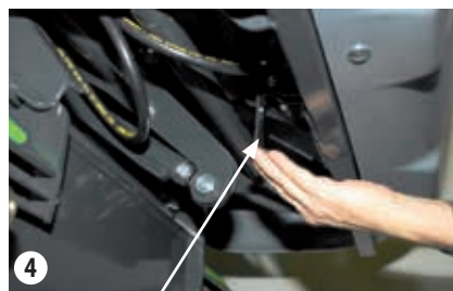
Apertura de la compuerta trasera
