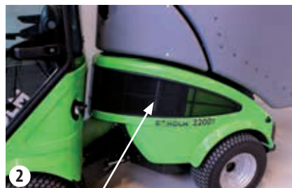
2 Limpieza de la rejilla del radiador de la máquina
