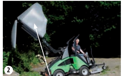
Colector basculado completamente hacia arriba
