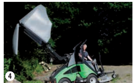
El colector de hierba está totalmente elevado y basculado completamente hacia atrás
