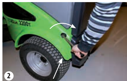
Gire la palanca de acoplamiento
