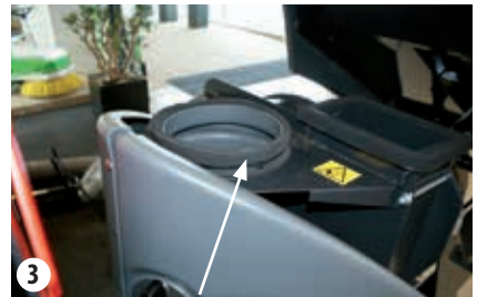
3 Anillo de junta colocado con cintas
