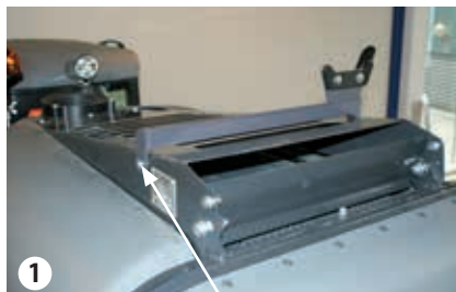
1 Bloqueo de transporte, gira sobre las cabezas de los tornillos
