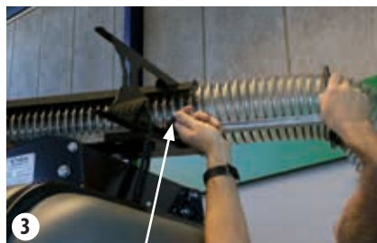
Afloje tornillo, despliegue, apriete tornillo
