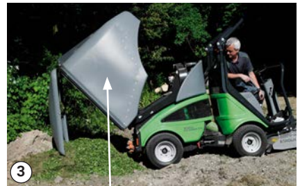
El colector de hierba está basculado completamente hacia atrás
