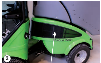
2 Función de arranque/parada: tras la cubierta trasera izquierda
