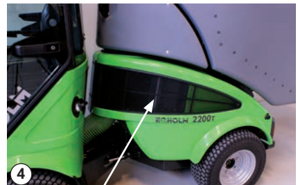
4 Limpieza de la rejilla del radiador de la máquina
