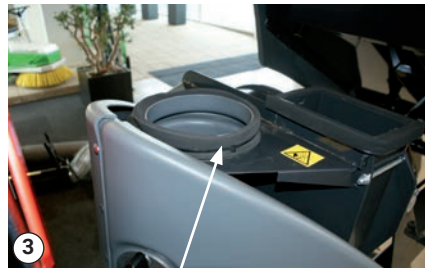
Anillo de junta colocado con cintas
