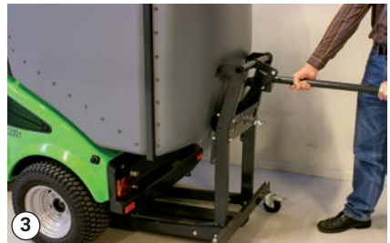
Colocación de colector de hierba
