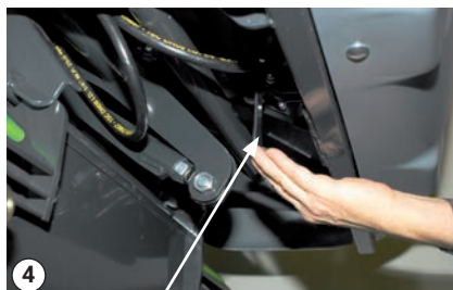
Apertura de la compuerta trasera
