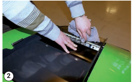
Limpieza de las conexiones
