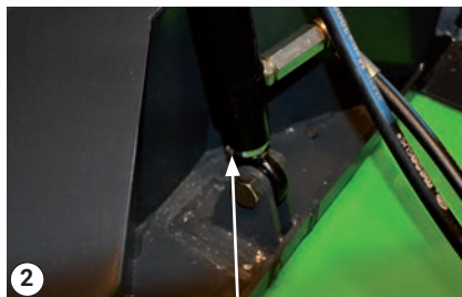
Lubricación de la boquilla por la parte inferior
