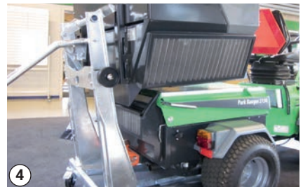
Instalación del colector en el vehículo
