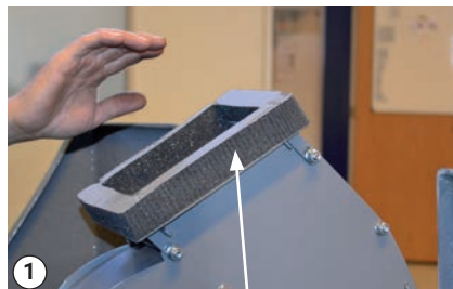
Sustitución de la junta de la turbina
