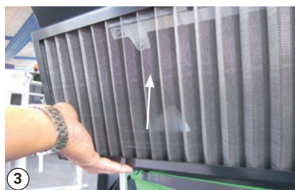
Levante el filtro de admisión de aire para liberarlo
