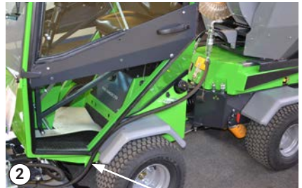
Sujeción de las mangueras hidráulicas, lateral izquierdo
