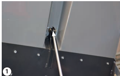
Lubricación de la boquilla por la parte superior
