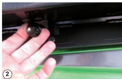
Extracción de una palanca del filtro
