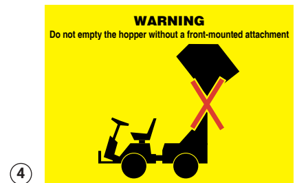
No vacíe el colector sin instalar antes un accesorio delantero
