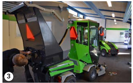
Empuje primero y haga descender después el colector sobre el capó
