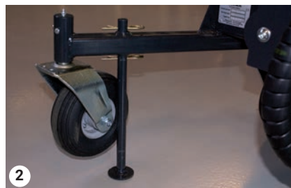
Puntal de apoyo bajado
