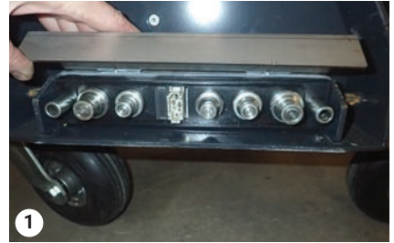
Limpieza de los acoplamientos
