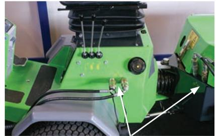
Monte las mangueras hidráulicas en los conectores B+C
