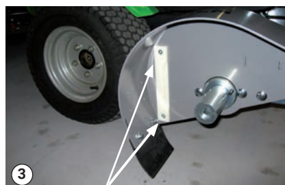
Tornillos que sostienen el patín de fricción
