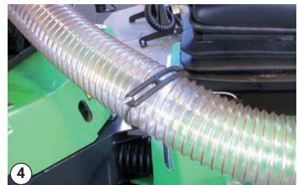
Fije la manguera de aspiración con la correa de goma para máquinas sin cabina
