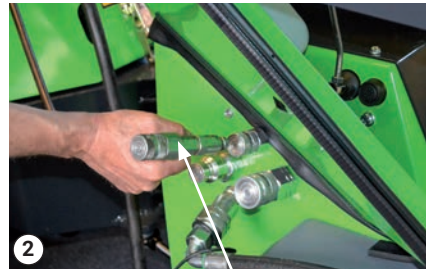
Manguera de desbordamiento de aceite en el conector D-3
