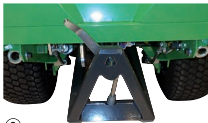
2 Mango de bloqueo en el bastidor A, abierto
