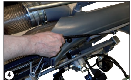
Cierre de transporte de la manguera de recogida de hojas
