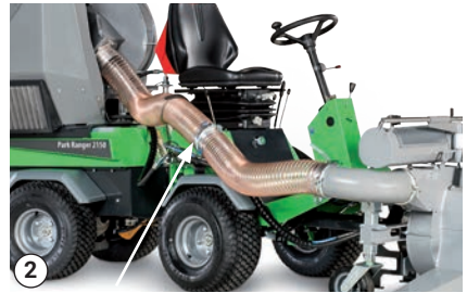
2 Conecte la manguera de aspiración con la pinza de la manguera
