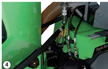
Asegure las mangueras hidráulicas - lado derecho Asegure las mangueras hidráulicas - lado izquierdo
