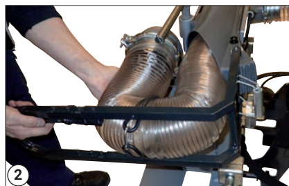
2 Ayude a la manguera de recogida de hojas a colocarse en su posición
