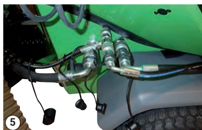
Mangueras hidráulicas conectadas – lado delantero
