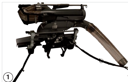
1 Extienda la manguera de aspiración y las mangueras hidráulicas hacia los lados antes de montar
