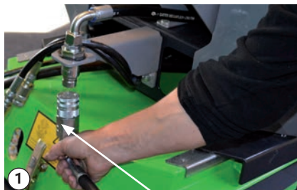
Manguera de retorno de la unidad de aspiración de hojas – con conector hembra
