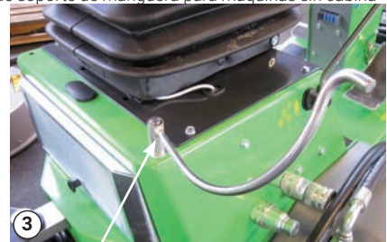
Monte el colgador de la manguera en el pasador roscado a la derecha detrás del asiento
