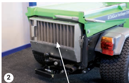
Cubierta del enfriador de agua
