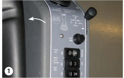
Empuje la palanca de gases hacia delante de modo que quede medio abierta
