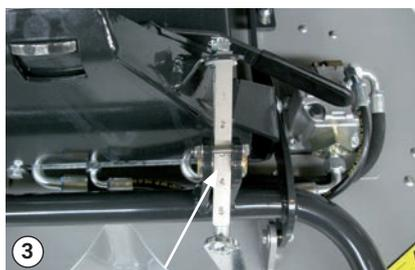
Escala de ajuste de la altura
