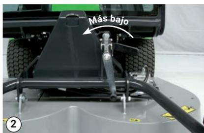
Palanca de ajuste: altura de corte más baja
