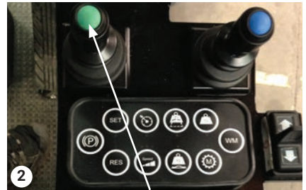
Manipulador izquierdo - Incline/baje el cortacésped.
