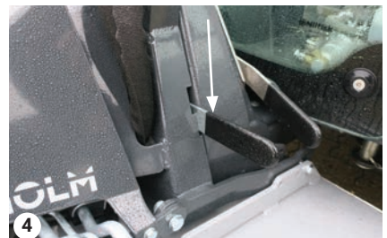
Bloqueo de inclinación - Mango en posición inferior
