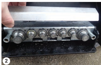
Limpie los acoplamientos hidráulicos
