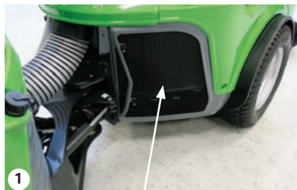
Rejilla de refrigeración
