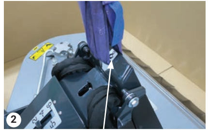
Marcas de puntos de elevación
