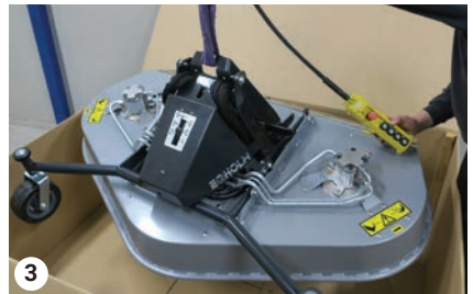
Marcas de puntos de elevación
