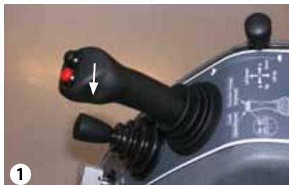
1 Palanca de ajuste: altura de corte más alta
