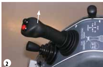
2 Palanca de ajuste: altura de corte más baja
