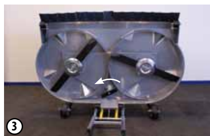
Sentido de la rotación de las cuchillas
