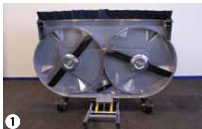
Bascule el cortacésped hacia delante
