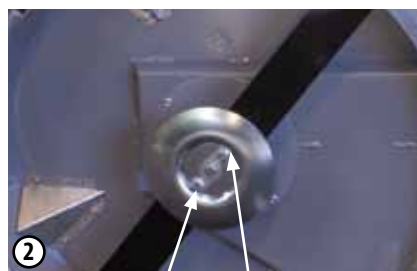
Tornillos y placa de seguridad
