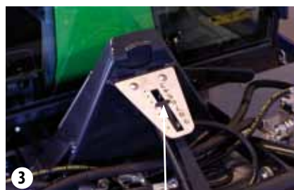
3 Escala de ajuste de la altura
