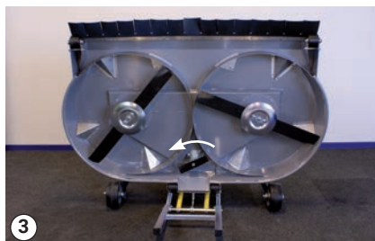
Sentido de la rotación de las cuchillas
