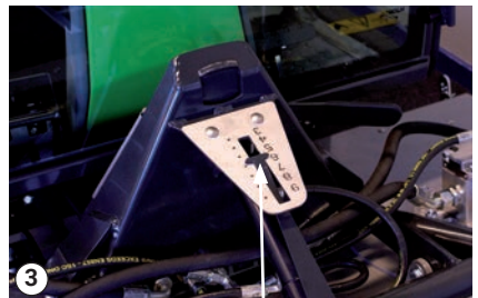
3 Escala de ajuste de la altura
