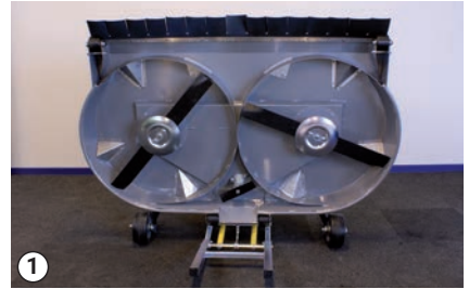
Bascule el cortacésped hacia delante
