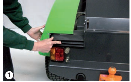
Abra las cubiertas laterales
