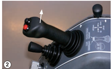
2 Palanca de ajuste: altura de corte más baja
