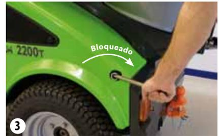
Gire la palanca de acoplamiento
