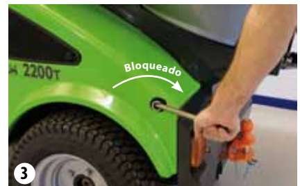
Gire la palanca de acoplamiento
