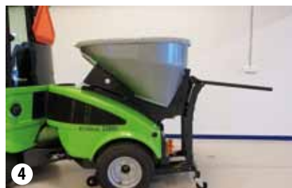
Instalación de la esparcidora
