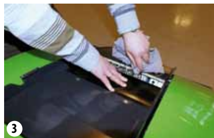
Limpieza de las conexiones
