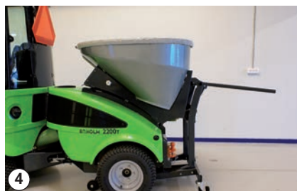
Instalación de la esparcidora
