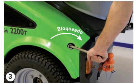
Gire la palanca de acoplamiento
