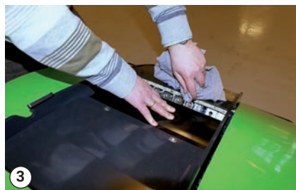
Limpieza de las conexiones
