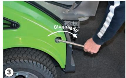
Gire la palanca de acoplamiento
