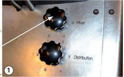
Mando "Mixer" para el ajuste de la velocidad de mezcla
