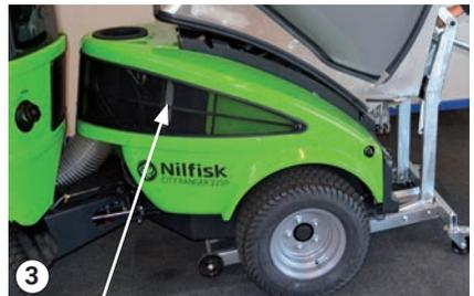
Función de arranque/parada: tras la cubierta trasera izquierda
