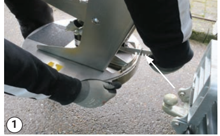
Regule el mango al esparcimiento asimétrico
