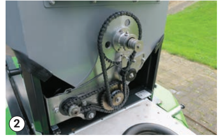
Compruebe y lubrique las cadenas
