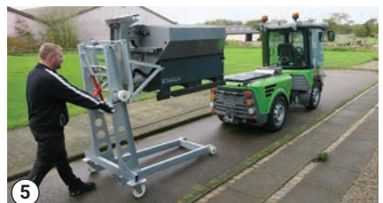
Remoción de la esparcidora o del vehículo básico
