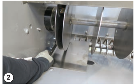
Afloje y quite 3 tornillos e instale el tope de sal deslizándolo hacia dentro desde el lado
