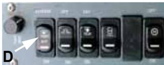
Por medio del interruptor (D) se puede conectar o desconectar el accionamiento de la fresa.
