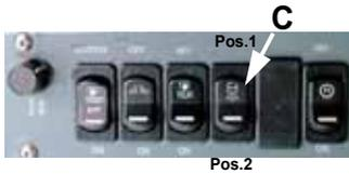
Accionando el interruptor (C) se puede ajustar la tapa de expulsión y modificar la distancia de lanzamiento.
