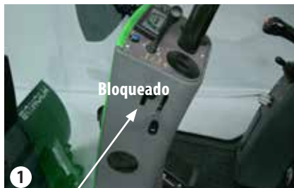
Bloqueo de transporte en posición bloqueada
