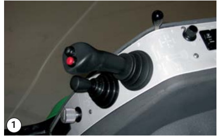
Levante la pala quitanieves con la palanca de mando
