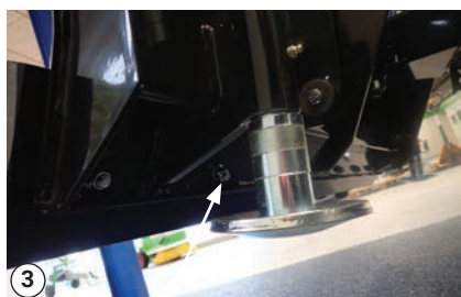
Afloje las tuercas de la parte posterior del borde
