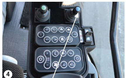
④ Giro de la pala quitanieves Levantamiento/descenso de la pala quitanieves
