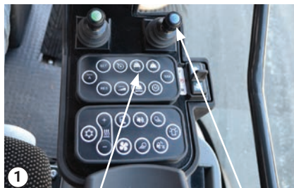
Botón de suspensión de carga y manipulador derecho
