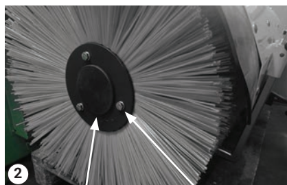
2 Desmontaje de la brida Perno
