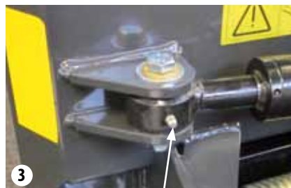
Colocación de las boquillas de lubricación
