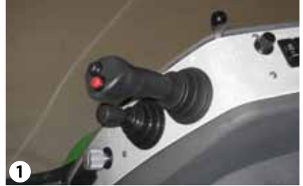
Levante la pala quitanieves en V con la palanca de mando
