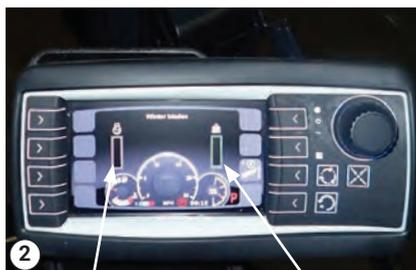
2 Barra para rpm del motor
