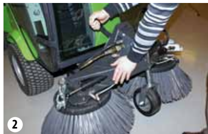
Incline el implemento para introducirlo en la máquina
