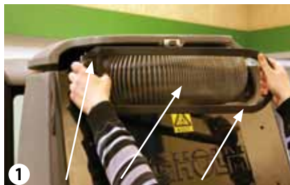
Bloqueo Boca de aspiración Palanca
