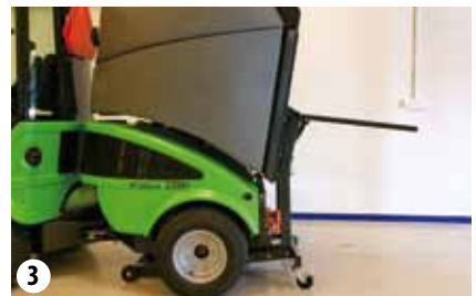
Colocación de la tolva
