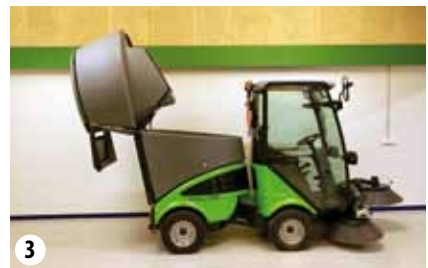
La tolva de residuos está basculada completamente hacia atrás
