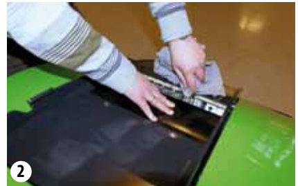
Limpieza de las conexiones
