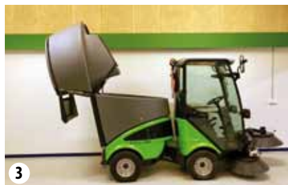
Tolva de residuos inclinada completamente hacia atrás
