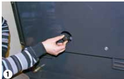
Tapón de desagüe
