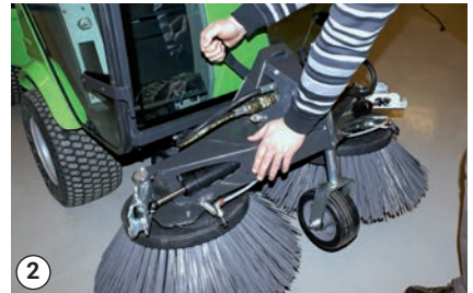
Incline el implemento para introducirlo en la máquina
