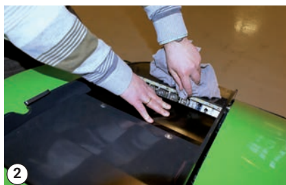
Limpieza de las conexiones
