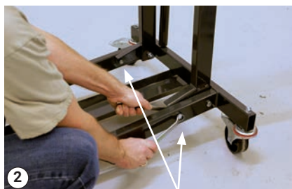
2 tornillos en el soporte de la tolva
