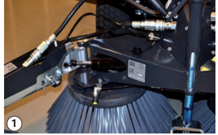
1 Instale las mangueras hidráulicas y la manguera para el agua en el bastidor A
