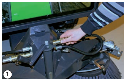
Desmonte la manguera hidráulica
