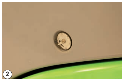
2 Nivel del depósito
