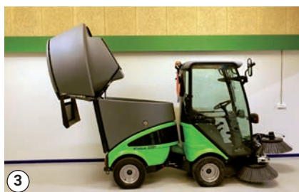
Tolva de residuos inclinada completamente hacia atrás
