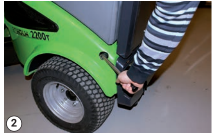
Gire la palanca de acoplamiento
